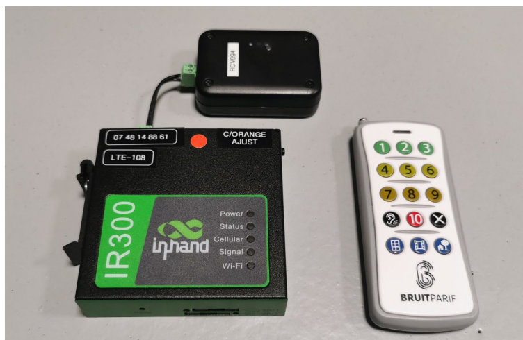
Télécommande pour la notation de la gêne instantanée avec routeur pour la transmission des données
