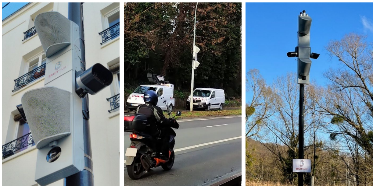
Le radar sonore "Hydre" installé sur trois sites pilote à Paris (à gauche), à Villeneuve-le-Roi (au milieu) et en Vallée de Chevreuse (à droite)
